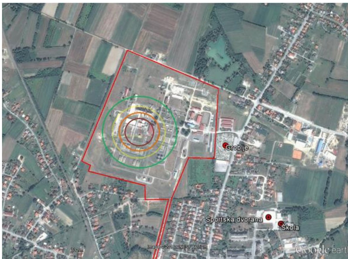
Slika 46. Zone ugroženosti uslijed zapaljenja oblaka para prirodnog benzina
