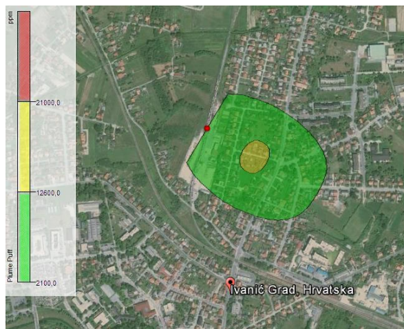
Slika 58. Disperzija oblaka zapaljivih/eksplozivnih para nakon 103 sekunde
