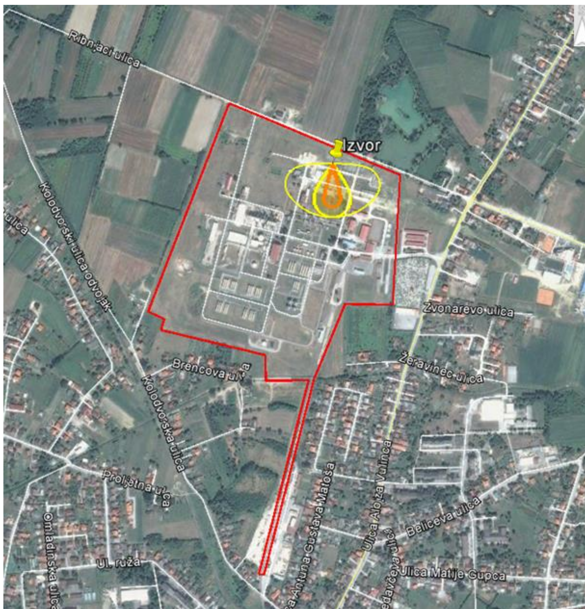
Slika 68. Zone ugroženosti uslijed eksplozije para prirodnog plina
