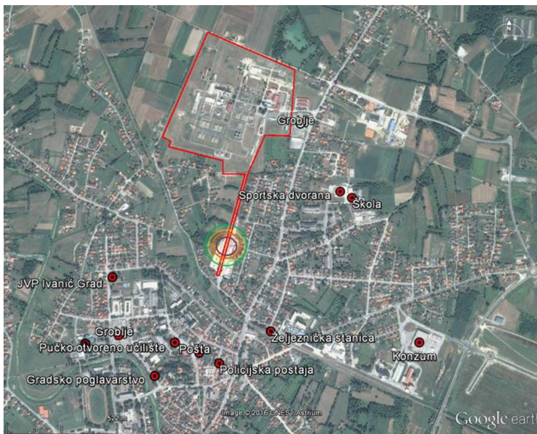
Slika 61. Zone ugroženosti uslijed zapaljenja oblaka para propana
