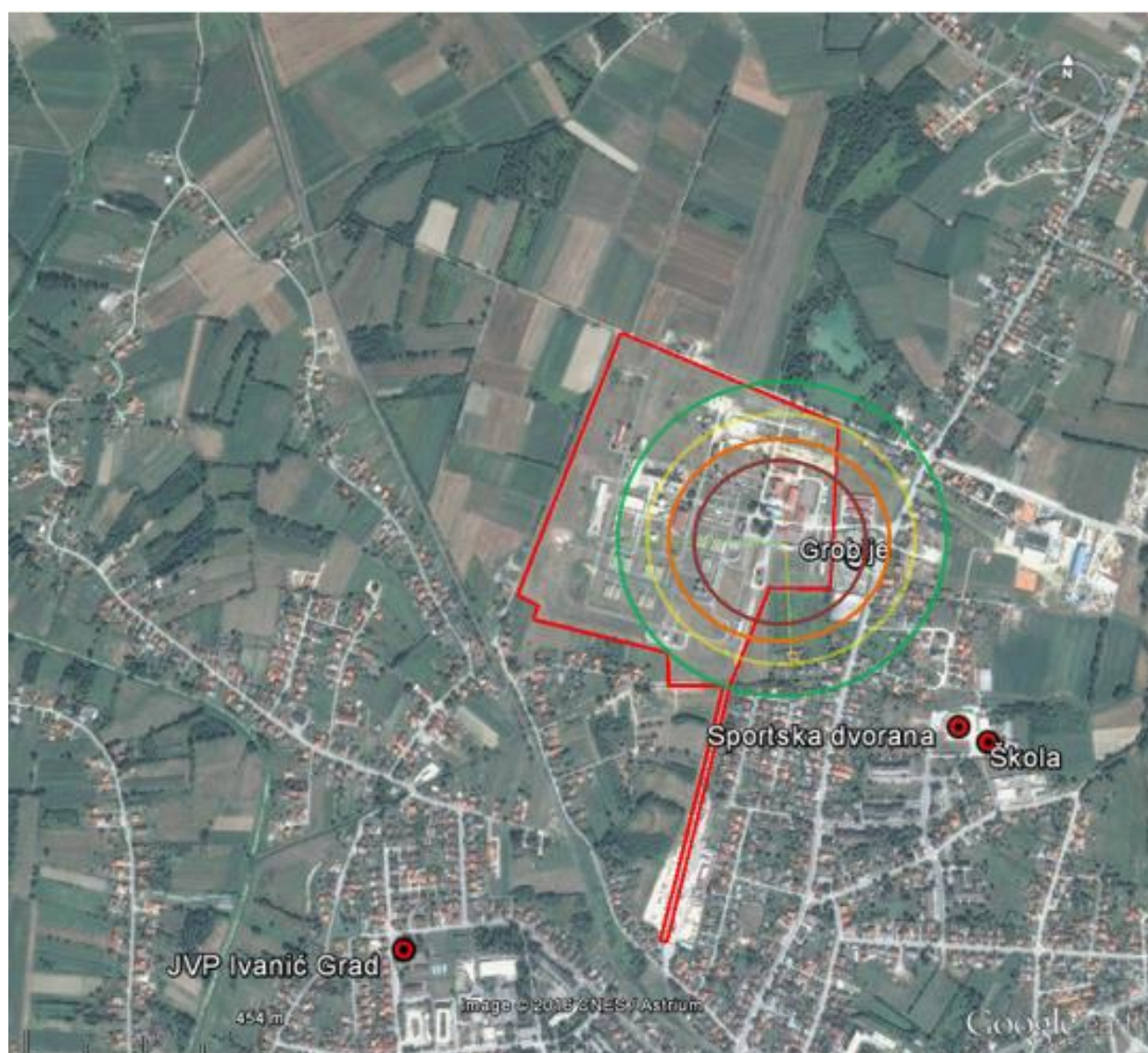
Slika 53. Zone ugroženosti uslijed zapaljenja oblaka para propana
