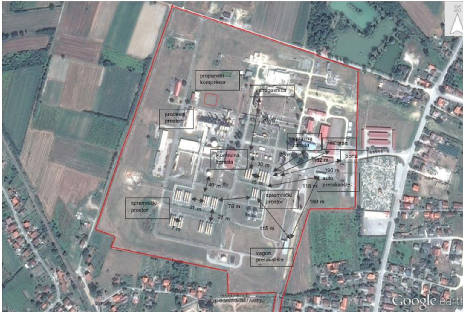
Slika 11. Prikaz međusobne udaljenosti objekata na području postrojenja OFIG
