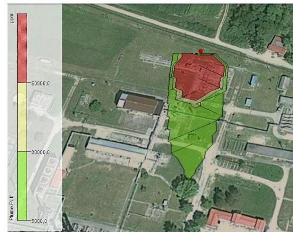
Slika 65. Disperzija oblaka zapaljivih/eksplozivnih nakon 140 sekunde
